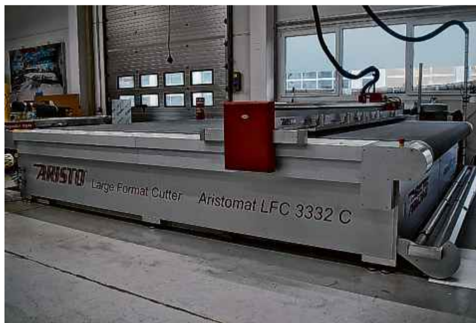
Der speziell für den Zuschnitt von großformatigen Rollen- aber auch Plattenmaterialien entwickelte Aristomat LFC-Large Format Cutter bietet die Voraussetzungen für einen optimierten Workflow.
