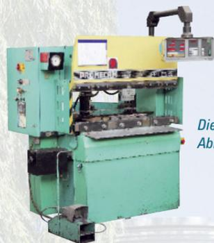
Die erste Maschine, eine Abkantpresse von Promecam.
