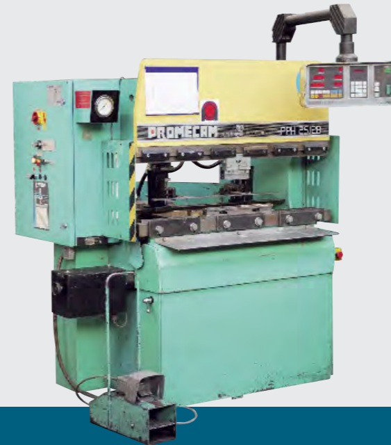
Das erste Stück im Maschinenpark: eine Abkantpresse von Promecam mit einer Kraft von 25 Tonnen
